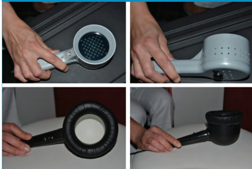
1. ábra: Felső sor: kézi mintázott ingerlő (HHPS). Alsó sor: Mini-Ganzfeld-stimulátor (MGF)
